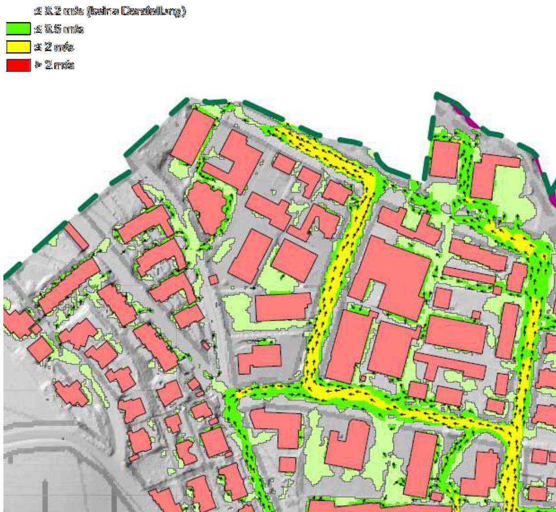
Ausschnitt Starkregengefahrenkarte mit den maximalen Fließgeschwindigkeiten „außergewöhnlich, verschlammte“ (ohne Maßstab), Stand 04/2020; Quelle: BIT Ingenieure
